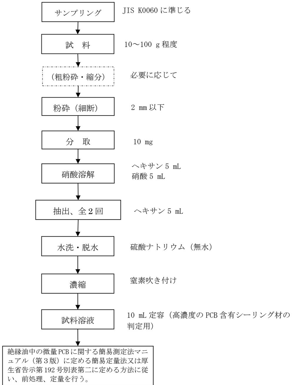
フローチャート：廃シーリング材（含有量試験）（低濃度 PCB 含有廃棄物の該当性判断及び
