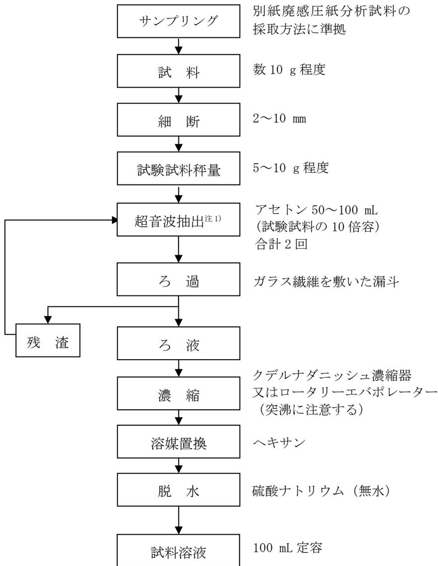
絶縁油中の微量PCBに関する簡易測定法マニュアル（第3版）に定める簡易定量法又は厚生省告示第192号別表第二に定める方法に従い、前処理、定量を行う。
