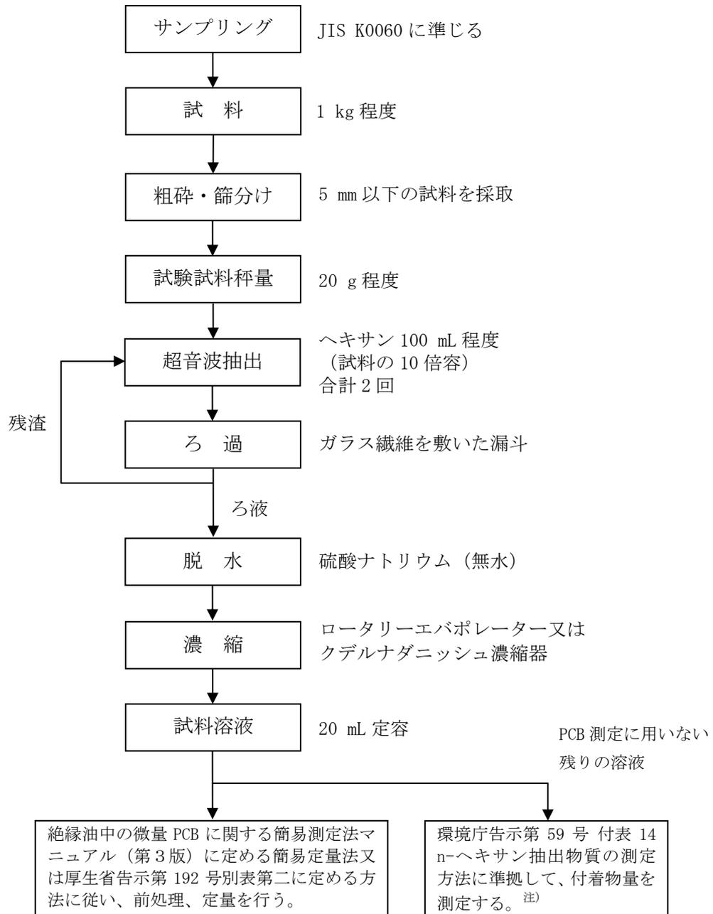
注：PCB 濃度が高い場合には、作業環境や周囲の汚染等、作業上の注意を要する。付着物量の測定より前に PCB 濃度を測定することが望ましい。
