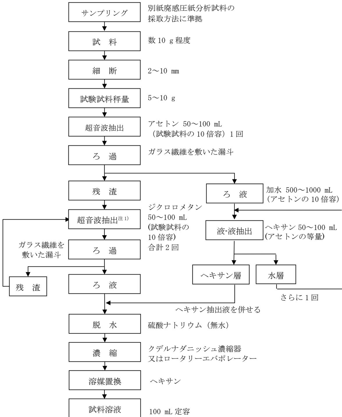
絶縁油中の微量PCBに関する簡易測定法マニュアル（第3版）に定める簡易定量法又は厚生省告示第192号別表第二に定める方法に従い、前処理、定量を行う。
